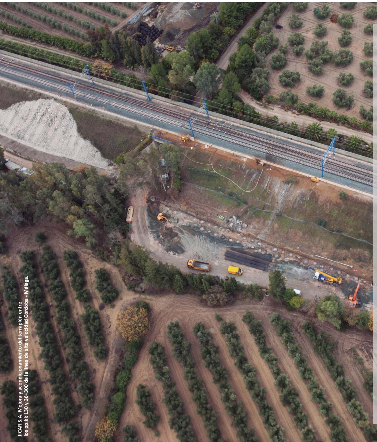
JICAR S.A. Mejora y acondicionamiento del terraplén entre los pp.kk 130 y 36+300 de la línea de alta velocidad Córdoba - Málaga.
